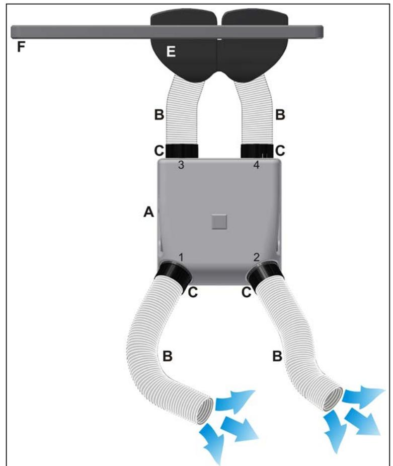
**HEIZFUNKTION:** 1 Schlauch (B) zwischen einer Lufteinlassöffnung (1 oder 2) und der Öffnung 3 anschließen; die **nicht verwendete** Lufteinlassöffnung (1 oder 2) muss mithilfe des Stopfens (D) am Mundstück (C) verschlossen werden. **Die warme Luft tritt aus der Öffnung 4 aus.**
