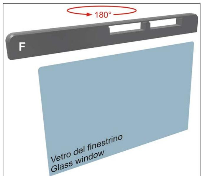
La partie inférieure du joint (**F**) est dotée d'une rainure le long de toute sa longueur; celle-ci devra être encastrée sur la partie supérieure de la vitre.
