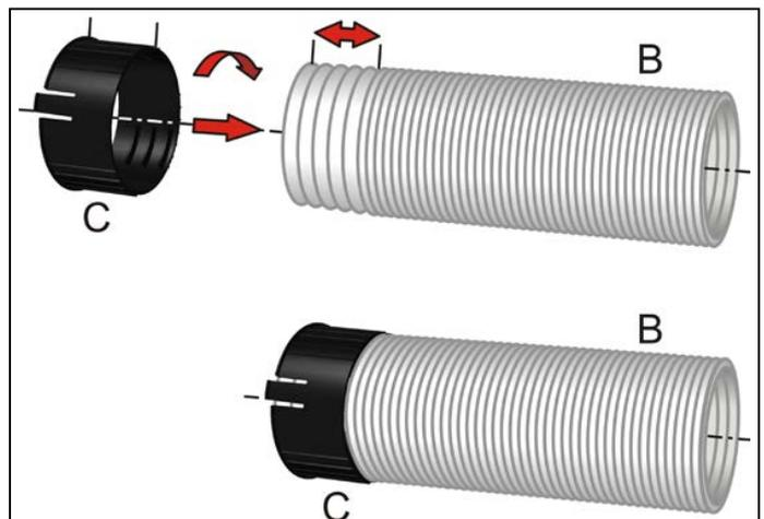
Para conectar los tubos flexibles (B) del "CUBE" solo es necesario encajar las pestañas de las bocas (C) en las fisuras dispuestas para ese fin en los diversos componentes y asegurarse de que se escucha el "CLICK".
