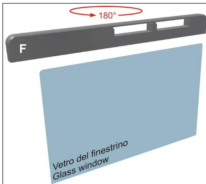
La parte inferiore della guarnizione (**F**) è dotata di una scanalatura lungo tutta la sua lunghezza; questa dovrà essere incastrata sulla parte superiore del vetro del finestrino.
