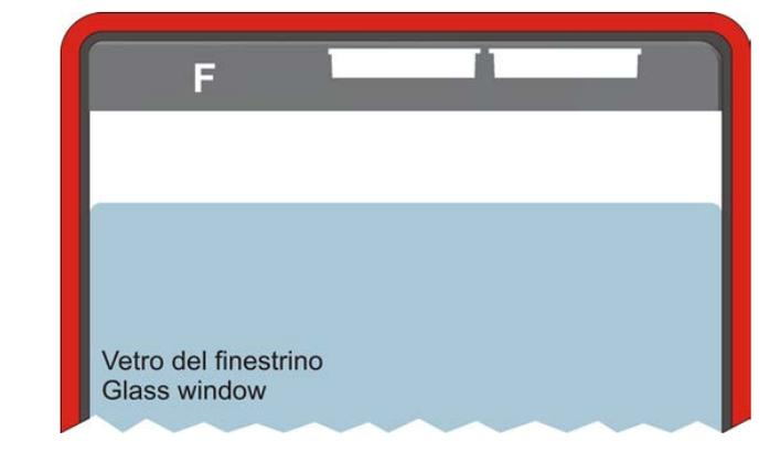
Dans le cas où l'on doit déplacer «**CUBE**» d'un véhicule à un autre (si le second est un modèle différent du premier) il pourrait être nécessaire de se doter d'un joint (**F**) à modeler en fonction de la configuration de la nouvelle vitre. A ce propos contacter INDEL B.
