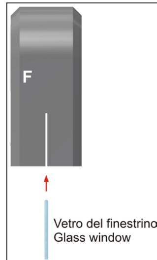
1 Posizionare la guarnizione (**F**) contro la parte superiore del vetro del finestrino (tenendo conto di quanto detto precedentemente), segnare e tagliare a misura seguendo il profilo del finestrino stesso.
