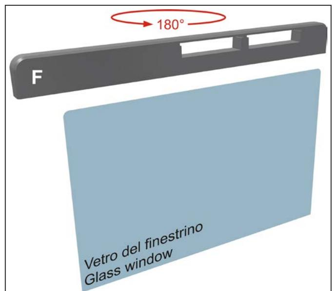
La parte inferior de la guarnición (**F**) está dotada de una estría que recorre todo su largo que tendrá que ser encajada en la parte superior del cristal de la ventanilla.
