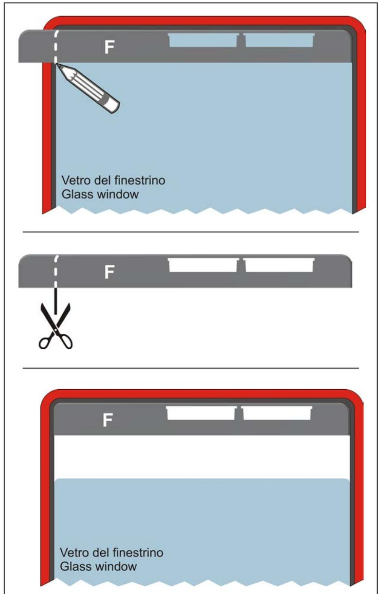
Falls **"CUBE"** in ein anderes Fahrzeug verlagert werden muss (und es sich bei dem zweiten Fahrzeug um ein abweichendes Modell handelt), könnte eine gemäß der neuen Fensterform modellierbare Dichtung (**F**) benötigt werden. In diesem Fall ist INDEL-B zu interpellieren.
