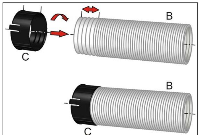
Pour raccorder les tubes flexibles (B) de «CUBE» il suffit encastrer les ailettes des embouchures (C) dans les fissures prédisposées sur les divers composants et s'assurer d'entendre «CLICK».
