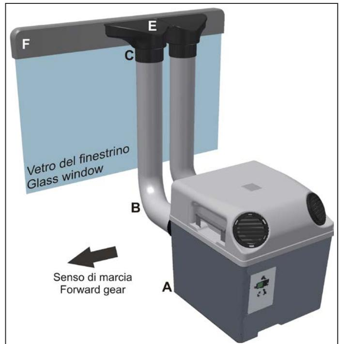
**ATTENTION:** pendant la marche il est indispensable que la visibilité aux rétroviseurs et à travers la vitre latérale NE SOIT PAS REDUITE. Dans ce but opter pour le positionnement de tubes, snorkel et joint de façon la moins envahissante possible; si la visibilité n'est pas garantie **déplacer "CUBE"** et les composants relatifs en position adaptée
